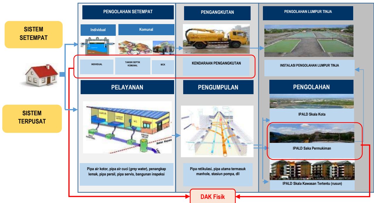
Gambar 4.6 Skema Pengolahan SPALDT dan SPALD
